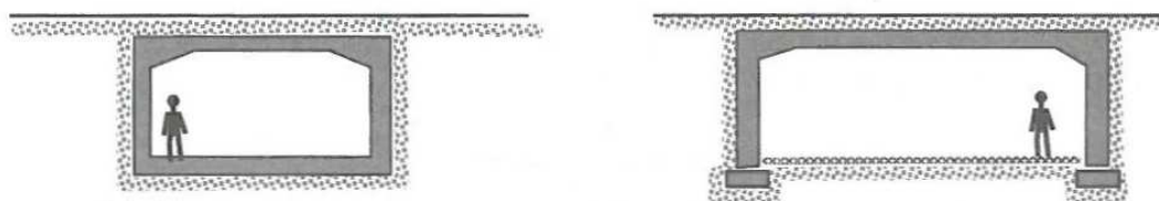
Obr. 20 Betonové rámové mosty – vlevo uzavřený, vpravo otevřený dvoukloubový
